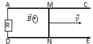
placé dans le plan des rails tout en restant perpendiculaire à ceux-ci, à la vitesse constante  $v = 0,8\text{m} \cdot \text{s}^{-1}$ . On néglige les frottements. Les rails et le conducteur MN ont une résistance négligeable.
