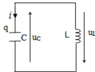
$$u_C + u_L = 0 \Rightarrow u + L \frac{di}{dt} = 0 \text{ avec } i = \frac{dq}{dt} \Rightarrow \frac{di}{dt} = \frac{d^2 q}{dt^2} \text{ et } u = \frac{q}{C}$$
