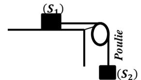
sans frottement autour d'un axe horizontal ( $\Delta$ ) passant par son milieu. Le moment d'inertie de la poulie par rapport à l'axe ( $\Delta$ ) est noté  $J_\Delta$ . On abandonne le système sans vitesse initiale.
