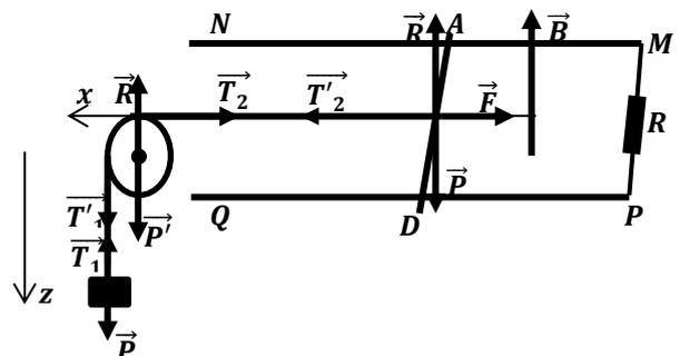
En utilisant la règle de trois doigts de main droite, la force de Laplace  $\vec{F}$  est horizontale et dirigée vers la gauche. Soit  $F = ilB$ .
