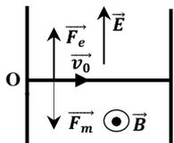
Dans cette nouvelle zone, la particule  $\alpha$  est soumise simultanément à la force électrostatique  $\vec{F}_e$  et à la force magnétique  $\vec{F}_m$ .
