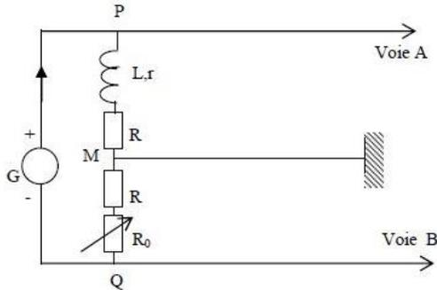
L'oscilloscope bi-courbe utilisé comporte une touche « ADD » permettant lorsqu'elle est actionnée, d'observer sur l'écran la tension  $u_{ADD}$  somme des tensions reçues sur les voies A et B :
