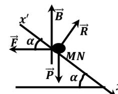
Si le champ magnétique est vertical, la force électromagnétique est toujours horizontale.
