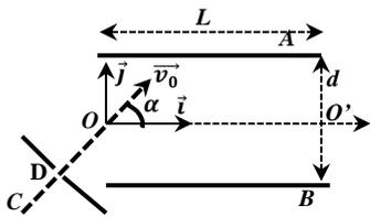
Un condensateur plan est constitué de deux plaques métalliques rectangulaires horizontales A et B de longueur L, séparées par une distance d.
