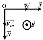
La particule  $\alpha$  dans le champ magnétique  $\vec{B}$  uniforme, est soumise à la force magnétique  $\vec{F}_m = |q|\vec{v}_0\wedge\vec{B}$ , elle est verticale et dirigée vers le bas.
