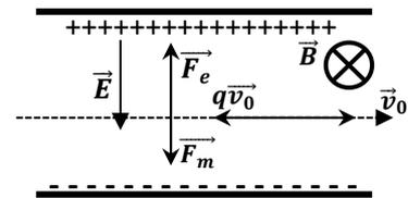
Seules les particules dans lesquelles la force électrique  $F_e$  et la force de Lorentz  $F_m$  sont égales et de sens contraire, ne sont pas déviées dans le filtre. Pour ces particules on a:
