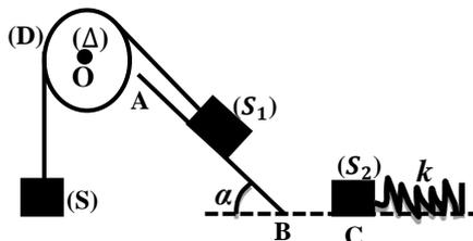
1. Le solide ( $S_1$ ) se déplace sur le plan incliné AB avec une accélération  $a = 2,5\text{ m.s}^{-2}$ .
