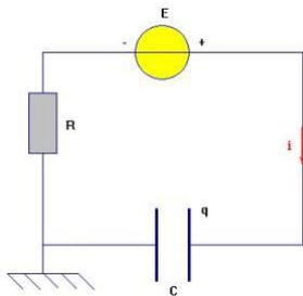
Avec l'orientation choisie, on peut écrire la loi d'Ohm aux bornes du conducteur ohmique :  $u_{MB} = u_R = Ri$
