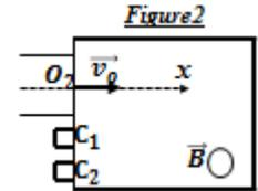
2. Les ions  ${}^6Li^+$  et  ${}^7Li^+$  sortant en  $O_2$  parallèle à  $O_2x$ , pénètrent dans une chambre de déviation où règne un champ magnétique uniforme  $\vec{B}$  (figure2).
