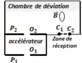
En  $O_1$ , la vitesse des ions est pratiquement nulle ; ils sont accélérés par la tension  $U = V_{P_1} - V_{P_2} = 6 \cdot 10^4 V$  appliquée entre les plaques  $P_1$  et  $P_2$ , distantes de 10cm. Ils pénètrent ensuite en  $O_2$ , dans un champ magnétique uniforme  $\vec{B}$  perpendiculaire au plan de la figure.
