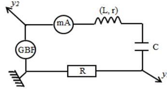
Voie  $y_1$  : on visualise la tension aux bornes de la résistance R.
