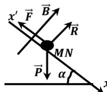
La tige est soumise à son poids  $\vec{P}$ , à la force électromagnétique  $\vec{F}$  et à la réaction de la piste  $\vec{R}$  de la piste.
