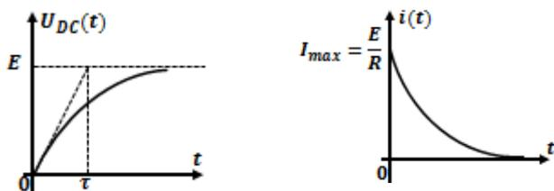
3. L'énergie emmagasinée dans le condensateur est dissipée par l'effet joule à travers la résistance ohmique R :
