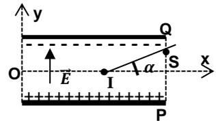
Les ions  $^{39}\text{K}^+, ^{40}\text{K}^+$  et  $^{41}\text{K}^+$  ont une trajectoire parabolique à l'intérieur du condensateur.
