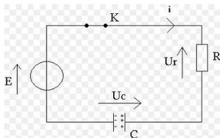
On cherche à modéliser l'équation différentielle de la charge du condensateur. A t=0, on ferme l'interrupteur K
