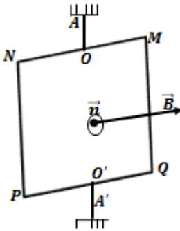
1. On écarte le cadre de sa position d'équilibre d'un angle  $\frac{\pi}{4}\text{rad}$  et on l'abandonne à  $t=0$ , sans vitesse initiale. La position du cadre est repérée par  $\theta = \theta_m \cos(\omega_0 t + \varphi)$ .
